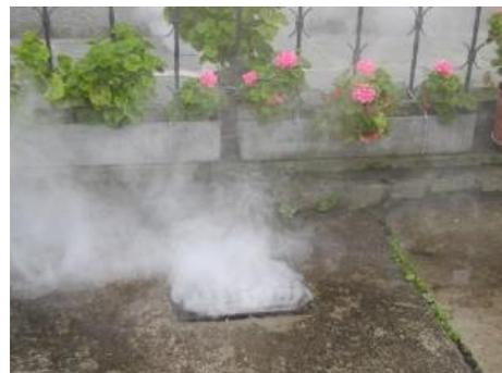
Bei dieser Nebelgerätüberprüfung wird in den Fäkalkanal künstlich erzeugter Nebel eingebracht und im Umgebungsbereich beobachtet, ob dieser bei Dachrinnen, Rigolen usw. austritt. Bei derart festgestellten unerlaubten Einleitungen werden die Liegenschaftseigentümer durch den Reinhaltverband bzw. in weiterer Folge durch die Gemeinde aufgefordert, diese Einleitungen vom Fäkalkanal abzutrennen.
